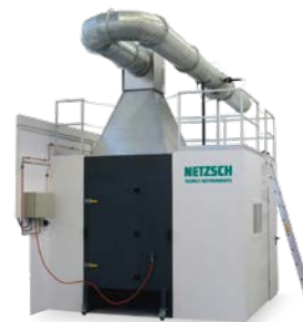
SBI 915 – Brandprüfeinrichtung für Bauprodukte
