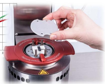
Damit ist es ebenso möglich, die typischen LFA-Proben ab einer Größe von 12,7 mm zu messen.
