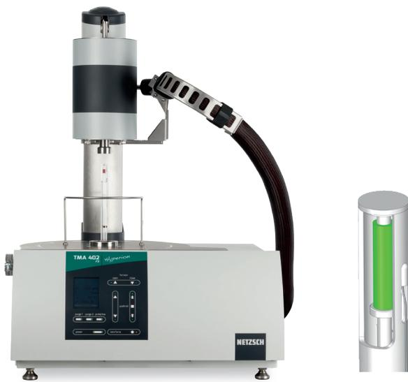
1 TMA 402 F3 Hyperion® Polymer Edition und der neue Probenhalter für Messungen im Expansionsmodus (rechts)
