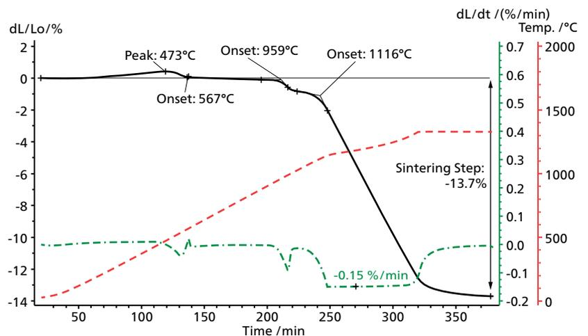
RCS-Messung im Expansionsmodus ( $\text{Al}_2\text{O}_3$ -Probenträger) mit SiC-Ofen zwischen RT und 1350 °C; Probenlänge: ca. 5,5 mm;  $\varnothing$  6-7 mm; RT bis 1350 °C; Heizrate 5 K/min; Isothermsegment 60 min bei 1350 °C; RCS-Start bei 1040 °C, Start-/Stop-Modus, Schwellwert: 0,15 %.
