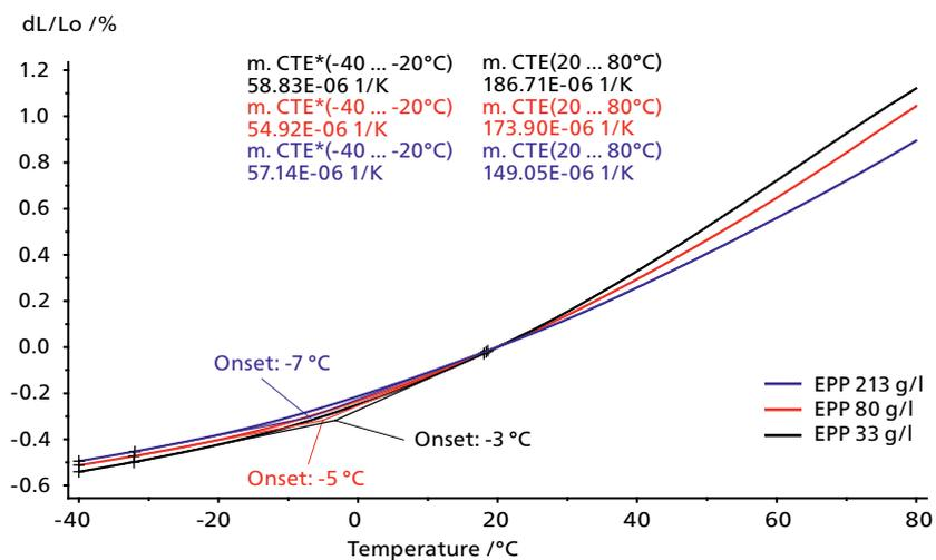
Ausdehnungsmessungen an drei verschiedenen EPP-Schäumen mit unterschiedlicher Dichte. Probenlänge 20 mm, Heizrate 5 K/min von -40 °C bis 80 °C unter  $N_2$ -Atmosphäre, Probenhalter für Expansion aus Quarzglas, Probenbelastung von 50 mN
