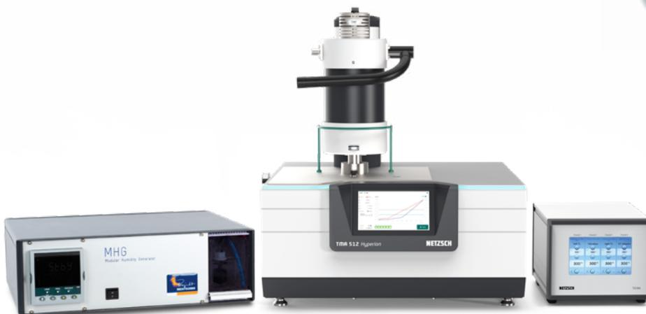
Feuchtgenerator, angeschlossen an die TMA 512 *Hyperion*®
