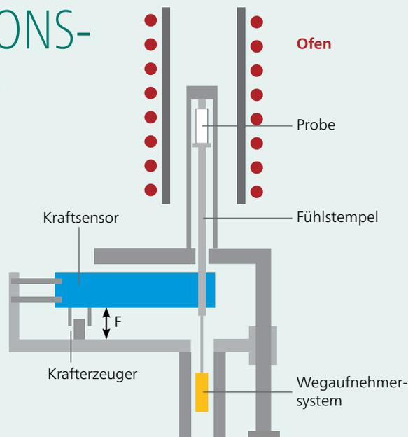
Unabhängig von der gewählten Deformationsart (Expansion, Kompression, Penetration, Zug oder Biegung) wird die Längenänderung der Probe über einen Fühlstempel auf einen hochempfindlichen induktiven Wegaufnehmer (LVDT) übertragen und in ein digitales Signal umgewandelt.
