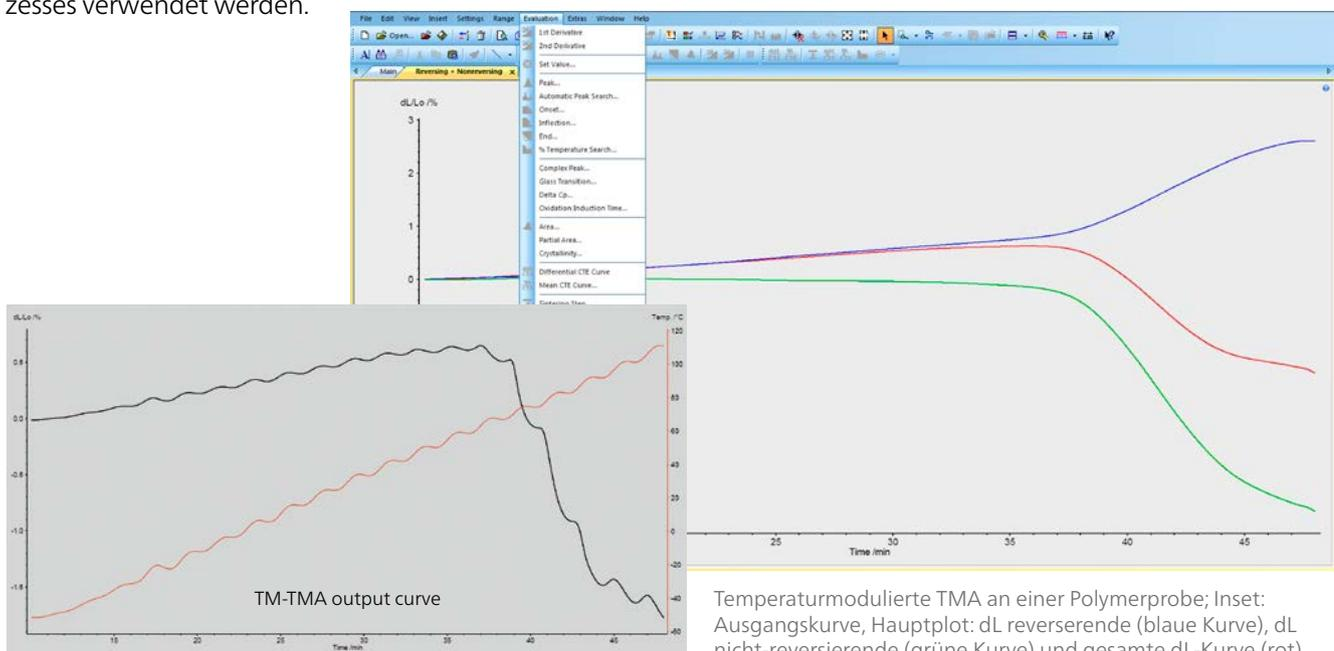
Temperaturmodulierte TMA an einer Polymerprobe; Inset: Ausgangskurve, Hauptplot: dL reversierende (blaue Kurve), dL nicht-reversierende (grüne Kurve) und gesamte dL-Kurve (rot)
