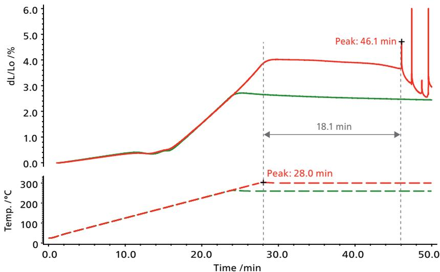
Bestimmung der Zeit bis zur Delamination an einer FR4-Verbundleiterplatte. Probengröße 6,35 mm<sup>2</sup> gemäß IPC-Norm, 2-stündige Trocknung vor der Messung bei 105 °C, Heizrate 10 K/min, N<sub>2</sub>-Atmosphäre, Probenhalter aus Quarzglas; Isothermsegment bei 260 °C bzw. 300 °C.
