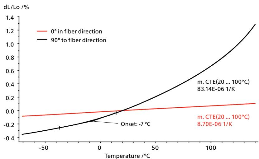
Komposit gemessen in zwei Richtungen; Probenlänge 25 mm, Heizrate 5 K/min von -70 °C bis 140 °C, N<sub>2</sub>-Atmosphäre, Probenhalter aus Quarzglas für den Expansionsmodus
