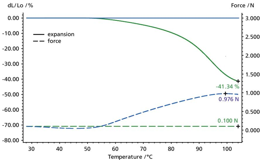
Messungen an einem Schrumpfschlauch unter konstanter Kraft (grüne Kurven) und unter konstanter Auslenkung (blaue Kurven). Aufheizung von RT bis 120 °C, N<sub>2</sub>-Atmosphäre, Probenlänge 25 mm (blau) bzw. 10 mm (grün).
