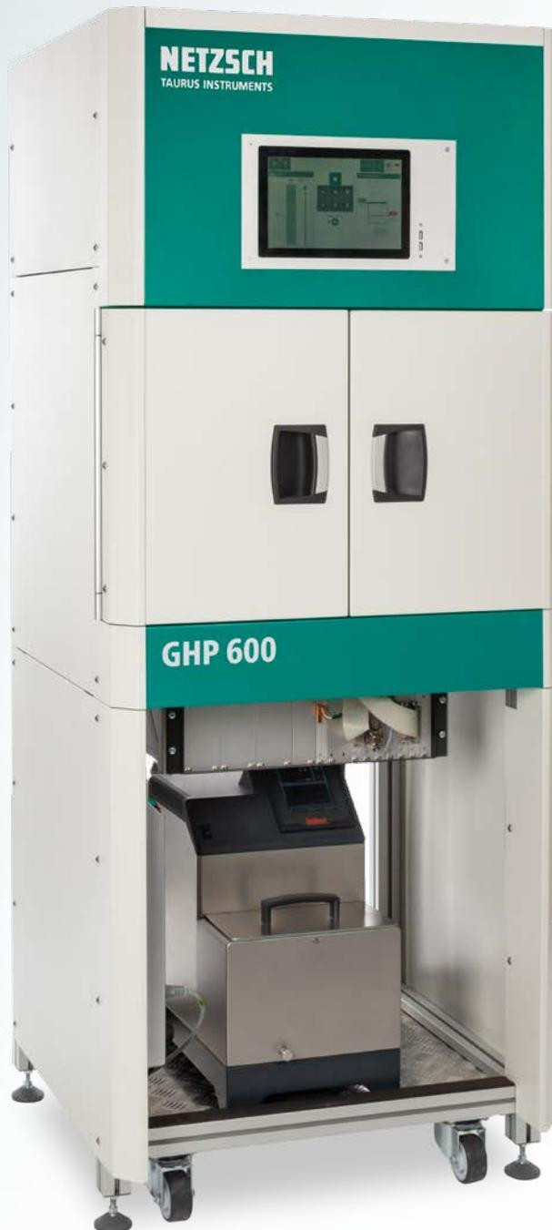
Messgerät mit geschützter Heizplatte gemäß ISO 8302, ASTM C177, EN 1946-2, EN 12664, EN 12667 und EN 12939
