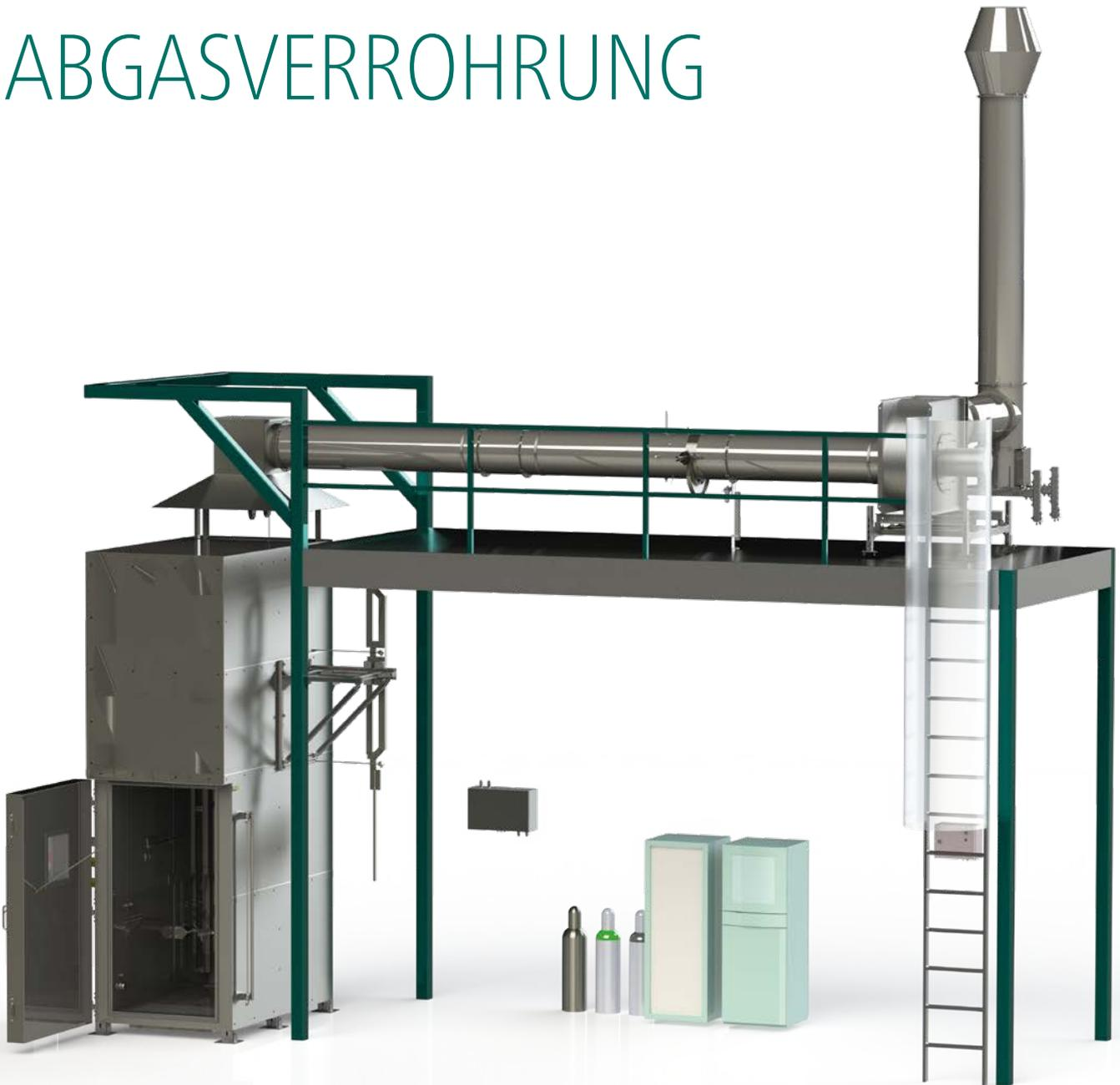
Schematische Darstellung des KBT 916, offene Prüfkammer mit Leiter.
