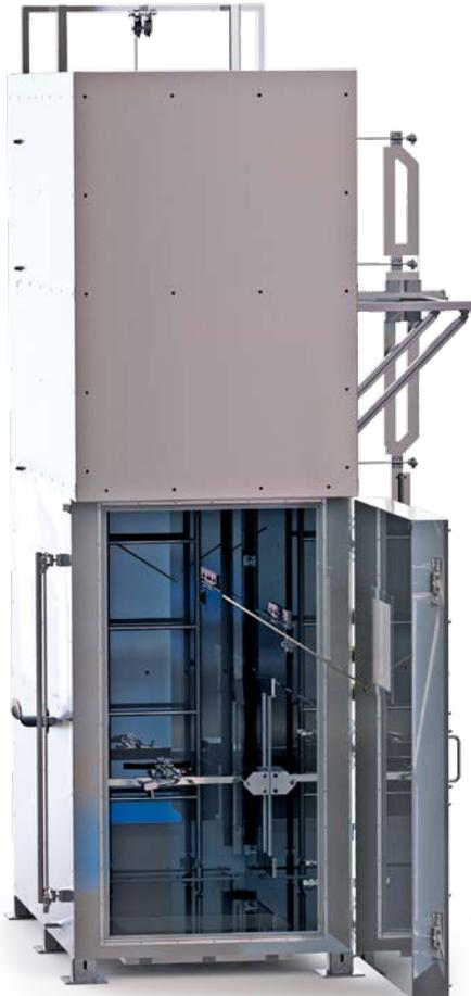
Prüfkammer mit Brenner und Probenhalter (Leiter)
