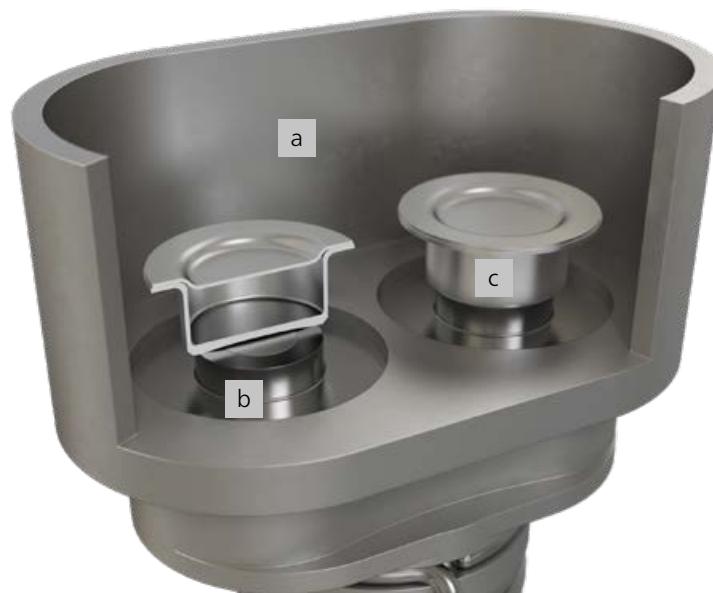
7 Das Zusammenspiel von Arena -Ofen (a), Ringsensor (b) und Concavus -Tiegeln (c). Die konkave Fläche ist zur Illustration stark überzeichnet; in der Realität ist die Wölbung nur ca. 10 µm.
