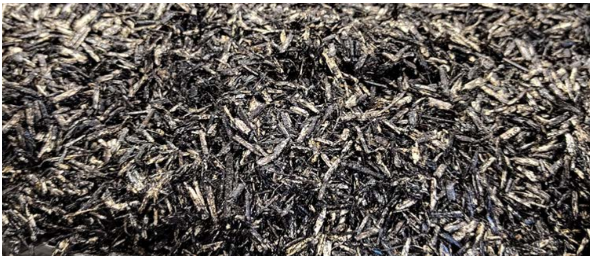
3 Dämmschüttung aus bituminierten Hanfstängeln
