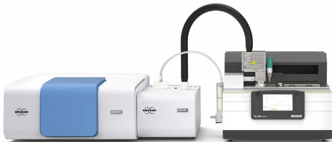
Bruker INVENIO mit externer Gaszelle und ATR-Einheit in der FT-IR Probenkammer
