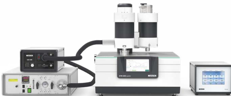
STA 509 Jupiter ® mit Wasserdampföfen, GSV 500 und Wasserdampfgenerator
