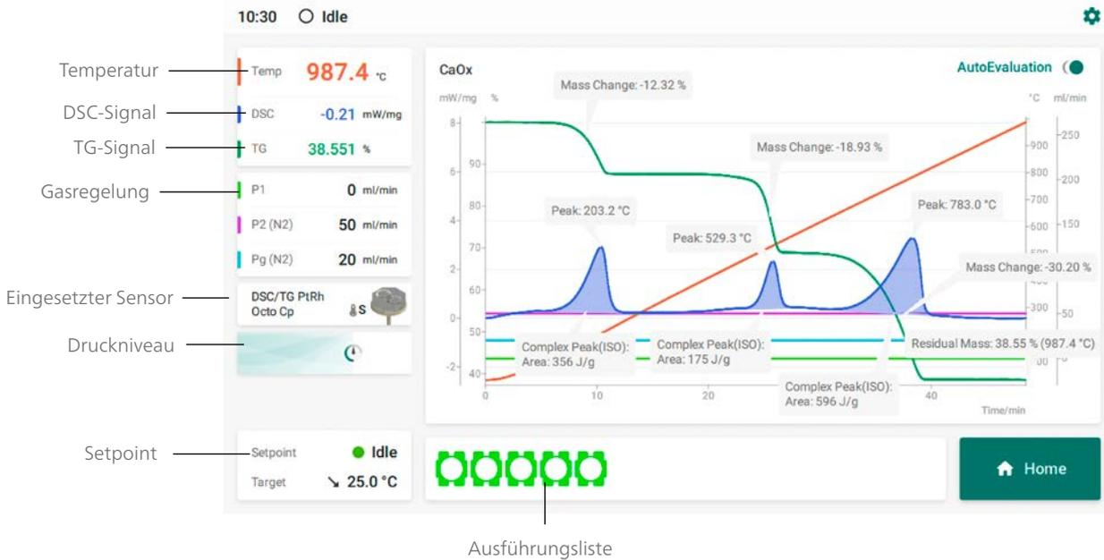
Überwachung Ihrer Messung leicht gemacht: Überwachung des Messfortschritts, Einstellung und Konfiguration von Sollwert und Gasfluss
