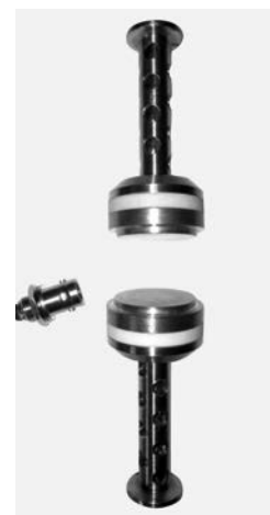
Kombinierter DEA- und DMTA-Probenhalter für kleine Proben
