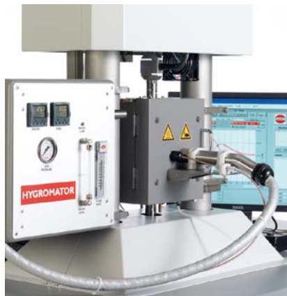
Feuchtgenerator, angeschlossen an den Standardofen
