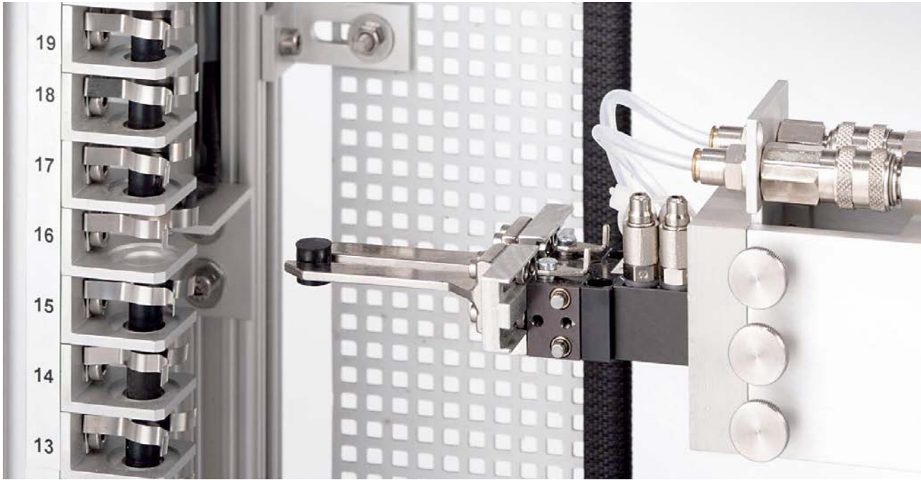
Autosampler (ASC) für Kompressionsmodus; nur die Probe wird ausgetauscht.
