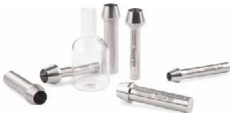
4 Probenbehälter für das NETZSCH MMC 274 Nexus®
