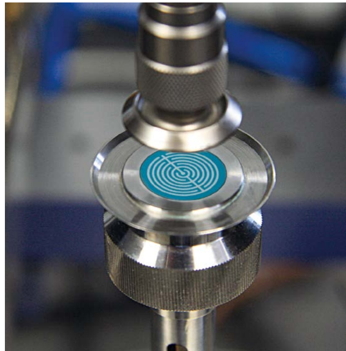
DEA 288 Ionic mit wiederverwendbarem TMCC-Sensor (Kammsensor mit 0,5-mm Elektrodenabstand), integriert in einem MARS III Rheometer (Platte-Platte, Abstand >0,6 mm)
