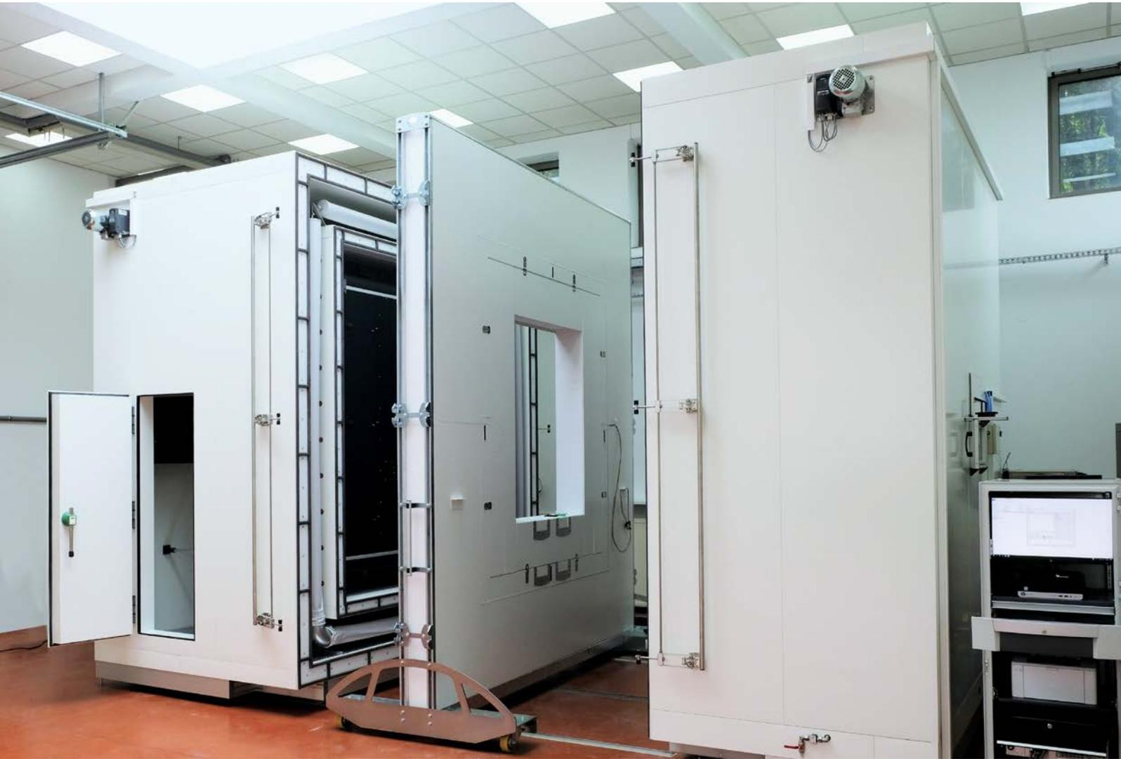
TDW 4240 (geöffnet) mit Prüfmassen für Fenster
