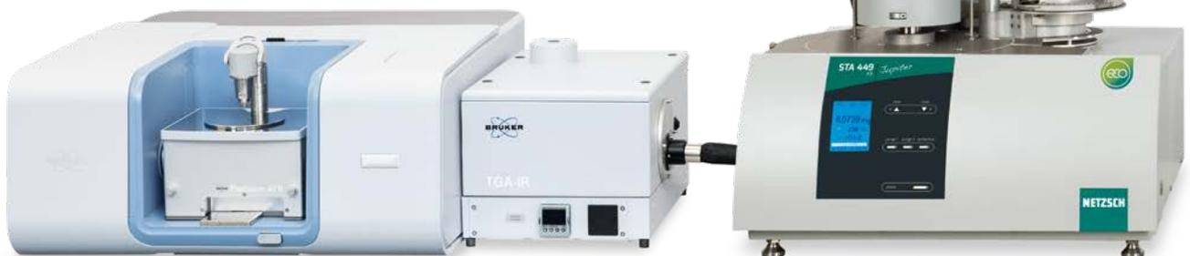
FT-IR Bruker Invenio ATR simultan gekoppelt an STA 449 *F3 Jupiter*<sup>®</sup> mit automatischem Probenwechsler und QMS 403 *Aëolos Quadro*
