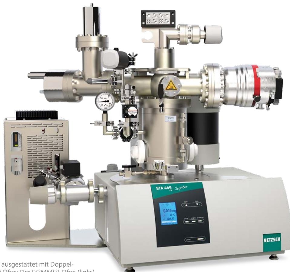
Die STA 449 **F3 Jupiter**®, ausgestattet mit Doppelhubvorrichtung für zwei Öfen: Der *SKIMMER*-Ofen (links) erlaubt die direkte Kopplung an ein Massenspektrometer für Emissionsgasanalyse (Option)
