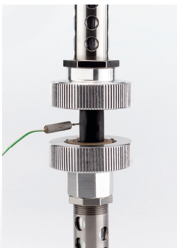
3 Probenanordnung mit Nadelthermoelement
