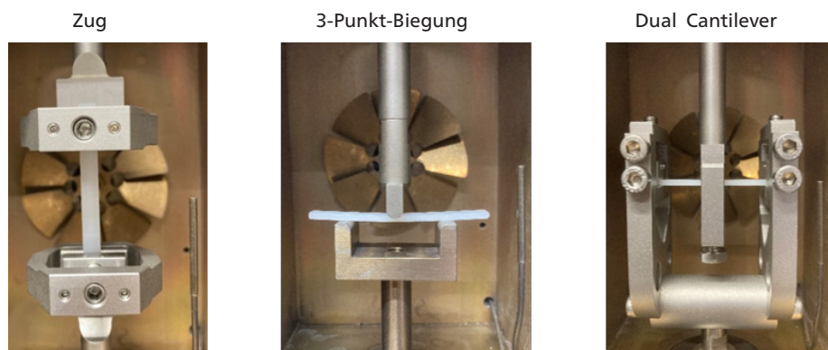
1 PE HD-Probe mit Abmessungen 55 x 5 x 2 mm in den verwendeten Probenhaltern
