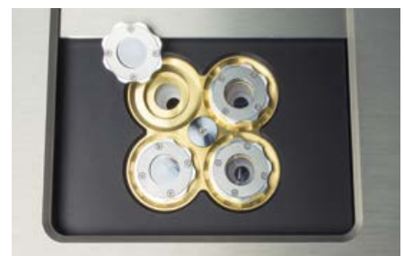
Abb. 3. Ofen mit integriertem automatischen Probenwechsler
