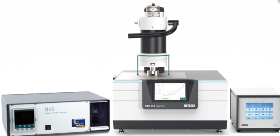
Feuchtgenerator, angeschlossen an die TMA 512 Hyperion®
