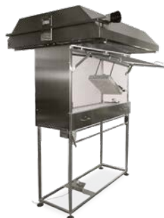
TBB 913 – Brandprüfeinrichtung für Bodenbeläge
