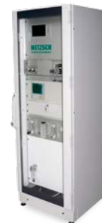
KBT 916 – Brandprüfeinrichtung für Kabelbündel
