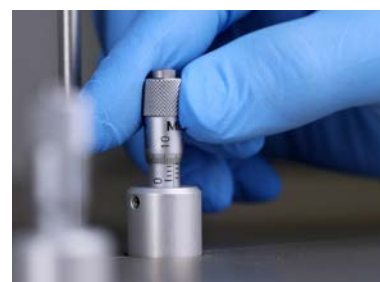
Abb. 2. Mikrometergenau Anpassung der Probenträgerposition
