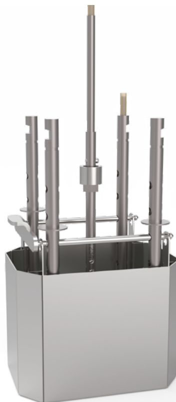
Zubehör für Flüssigimmersion für alle verfügbaren Probenhalter
