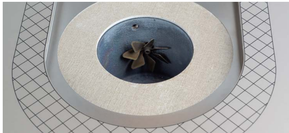
Blick in den DMA-Ofen mit Lüfter
