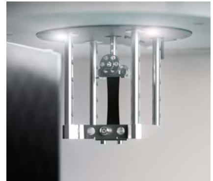
Hängendes Design mit beleuchtetem Probenhalterbereich
