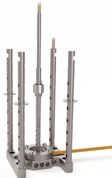
Probenhalter für simultane DMA-DEA
