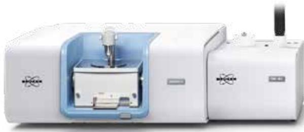
4 Bruker *INVENIO* Spektrometer ausgestattet mit einer ATR-Einheit
