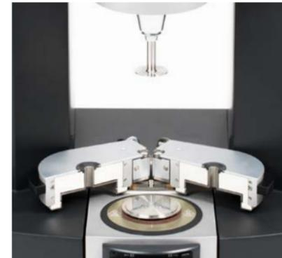
*Easy Swap* Temperiermodul zur Minimierung thermischer Gradienten bei Kegel-Platte- und Platte-Platte-Messgeometrien
