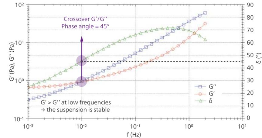
Oszillationsdaten eines partikelhaltigen Duschgels mit Elastizitätsmodul  $G'$  (rot), Viskositätsmodul  $G''$  (blau) und Phasenwinkel (Delta, grün) gegen die Frequenz (Hz); gemessen mit C25 Innen- und Außenzylinder, 2 Hz – 10<sup>-3</sup> Hz abwärts 1% Scherdeformations-Amplitude
