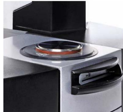
*Easy Swap* Temperiermodul für Kegel-Platte- und Platte-Platte-Messgeometrien
