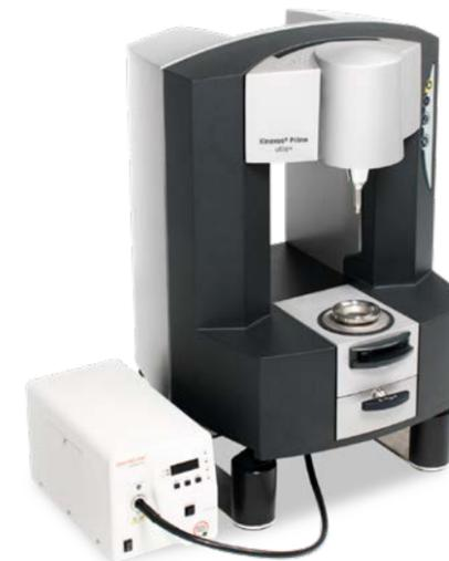
Kinexus Prime ultra+, ausgestattet mit UV-Aushärtensystem (KNX5007). Der abgebildete System-Stand zum Höherstellen des Kinexus ist nicht in der UV-Zelle KNX5007 enthalten und kann separat bestellt werden (KNW5010).
