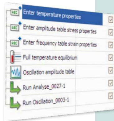
Die rSpace-Software wird durch Sequenzen gesteuert, die aus grundlegenden rheologischen Aktionen (oder Testbausteinen) bestehen. Diese können zur Erstellung intelligenter Tests mit weiteren Testaktionen verknüpft werden, wie z.B. Anwenderfeedback und Auswahlmöglichkeiten, Berechnung von Werten, Schleifen und Triggern.
