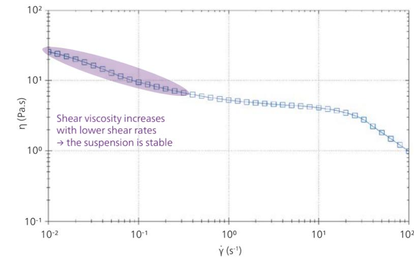
Viskositätskurve eines Duschgels mit Partikeln; Scherviskosität (Pa.s) gegen die Scherrate (1/s); Geometrie: Außen- und Innenzylinder: 25 mm; Temperatur: 25 °C; Scherraten: 0,01 s<sup>-1</sup> bis 100 s<sup>-1</sup>
