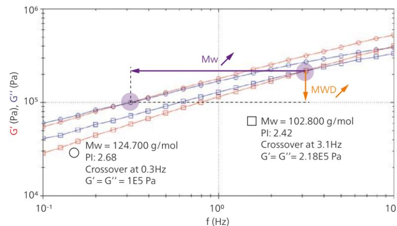
Oszillation: Frequenzsweep an zwei glasfasergefüllten Polyamidschmelzen mit unterschiedlichem Molekulargewicht: Elastischer Schubmodul  $G'$  (rot); viskoser Schubmodul  $G''$  (blau) gegen die Frequenz (Hz)
