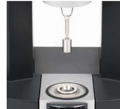
*Easy Swap* Temperiermodul für koaxiale Zylinder-Geometrien
