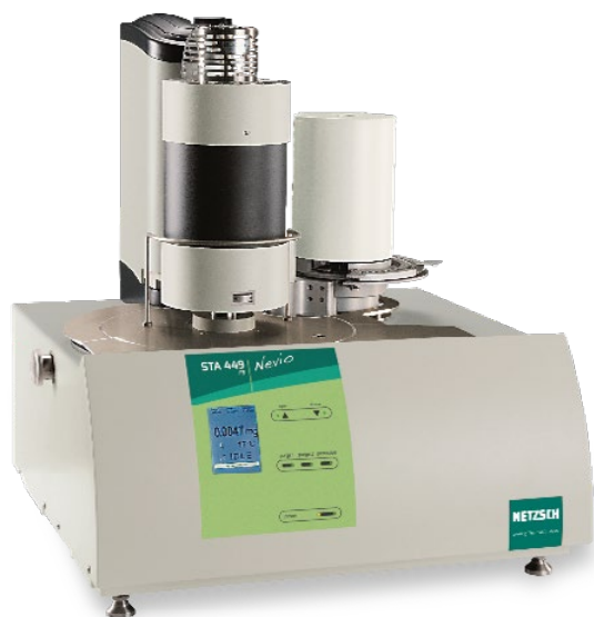
Fig. 1. STA 449 F3 Nevio and humidity generator
