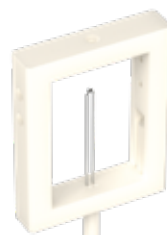
TGA 試料ホル ダー + 大容 量容器
