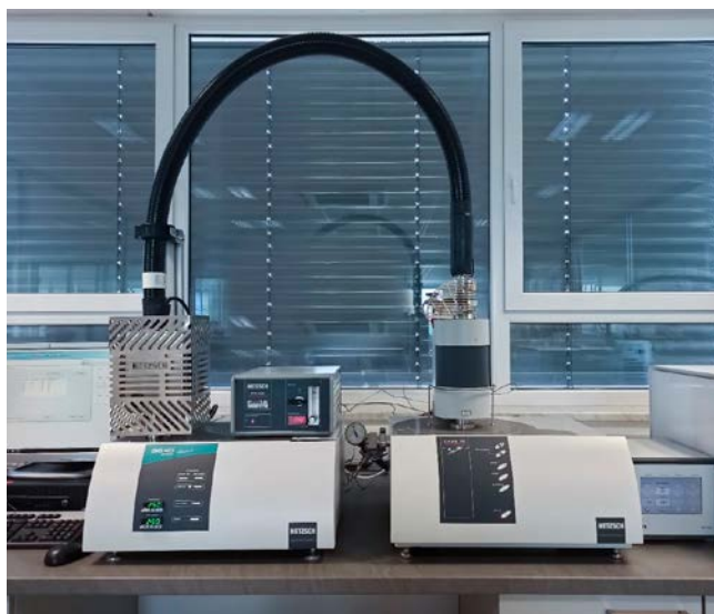
Abb. 1. Aufbau der PulseTA mit einer NETZSCH STA 449 F5 Jupiter ® und QMS 403 Aëolos ® Quadro
