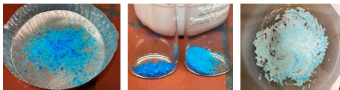
Abb. 3. a) und b): Ausgangsmaterial von Kupfersulfat-Pentahydrat und c) als zerkleinertes Pulver in einer Mörserschale
