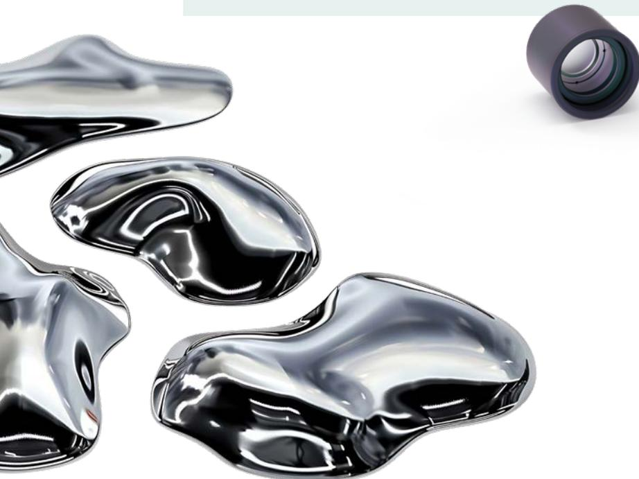
Die Wärmeleitfähigkeit von elementarem Silber zählt zu den höchsten aller heute bekannten Metalle. Silber und seine Legierungen werden aufgrund ihrer Fähigkeit, Wärme von empfindlichen Teilen abzuleiten, häufig in der Elektronikindustrie eingesetzt. Die Wärmeleitfähigkeit ist daher von großem Interesse.
