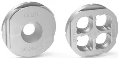
Probenhalter für Folien (links), Standard-Probenhalter für bis zu 4 runde Proben (rechts)
