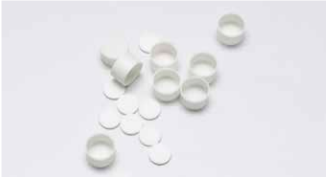
Abb. 3. Al 2 O 3 -Tiegel und Scheiben zur Messung von Pulvern in der TMA
