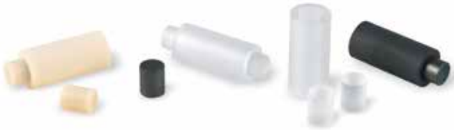
Abb. 1. Probencontainer aus \text{SiO}_2 , \text{Al}_2\text{O}_3 , Saphir und Graphit
