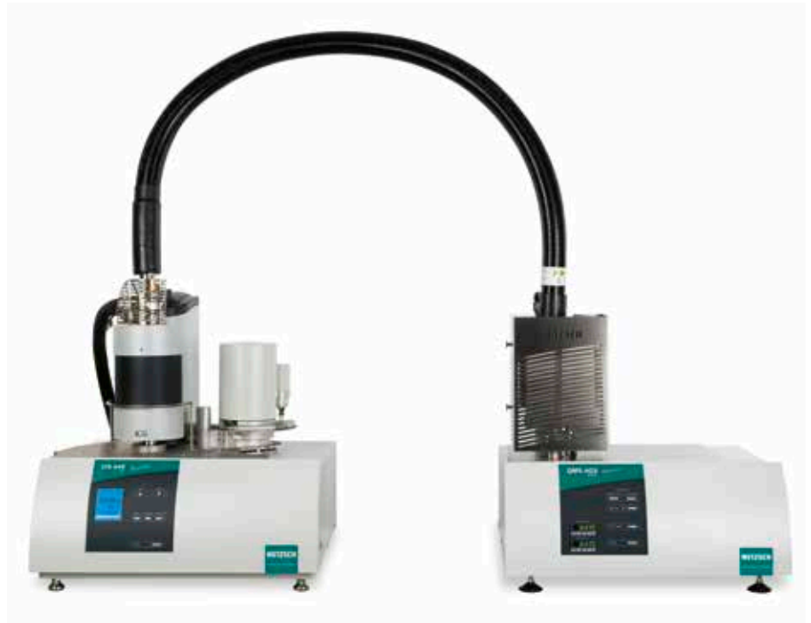
Abb. 1. Das neue QMS 403 Aëolos® Quadro, gekoppelt an die STA 449 F1 Jupiter ®
