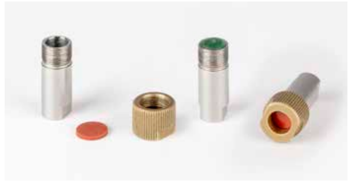
Abb. 4. Stahlcontainer für die Messung von Wachsen
