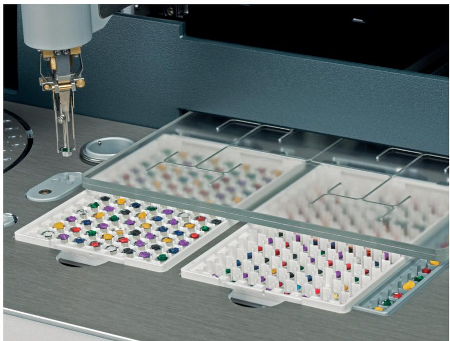
Abb. 3. Probenwechsler mit halb geöffneter Magazinabdeckung
