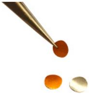
Abb. 3. Einzelfolien aus der Mehrschichtfolie
