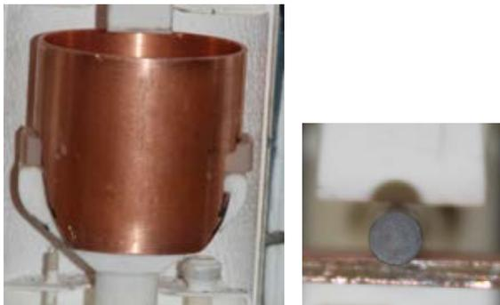
2 Thermisches Schutzschild (Cu), links, und kardanisch wirkender Druckstempel, rechts
