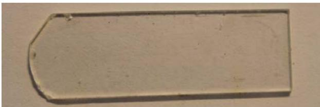
3 Unbeschädigte Waferprobe nach mehreren Tests
