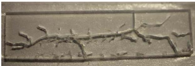
1 Selbstzerstörte Quarzwaferprobe
