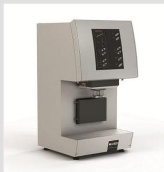
Die dynamisch-mechanische Analyseapparatur DMA 242 E Artemis bietet durch das modular aufgebaute System eine hohe Investitionssicherheit. Das Gerät kombiniert einfache Handhabung mit der benutzerfreundlichen Mess- und Auswertesoftware Proteus. Dies ermöglicht eine schnelle, einfache und praxisorientierte Charakterisierung dynamisch-mechanischer Eigenschaften. So ist eine Standard-Datenanalyse bereits in weniger als einer Minute erledigt.
