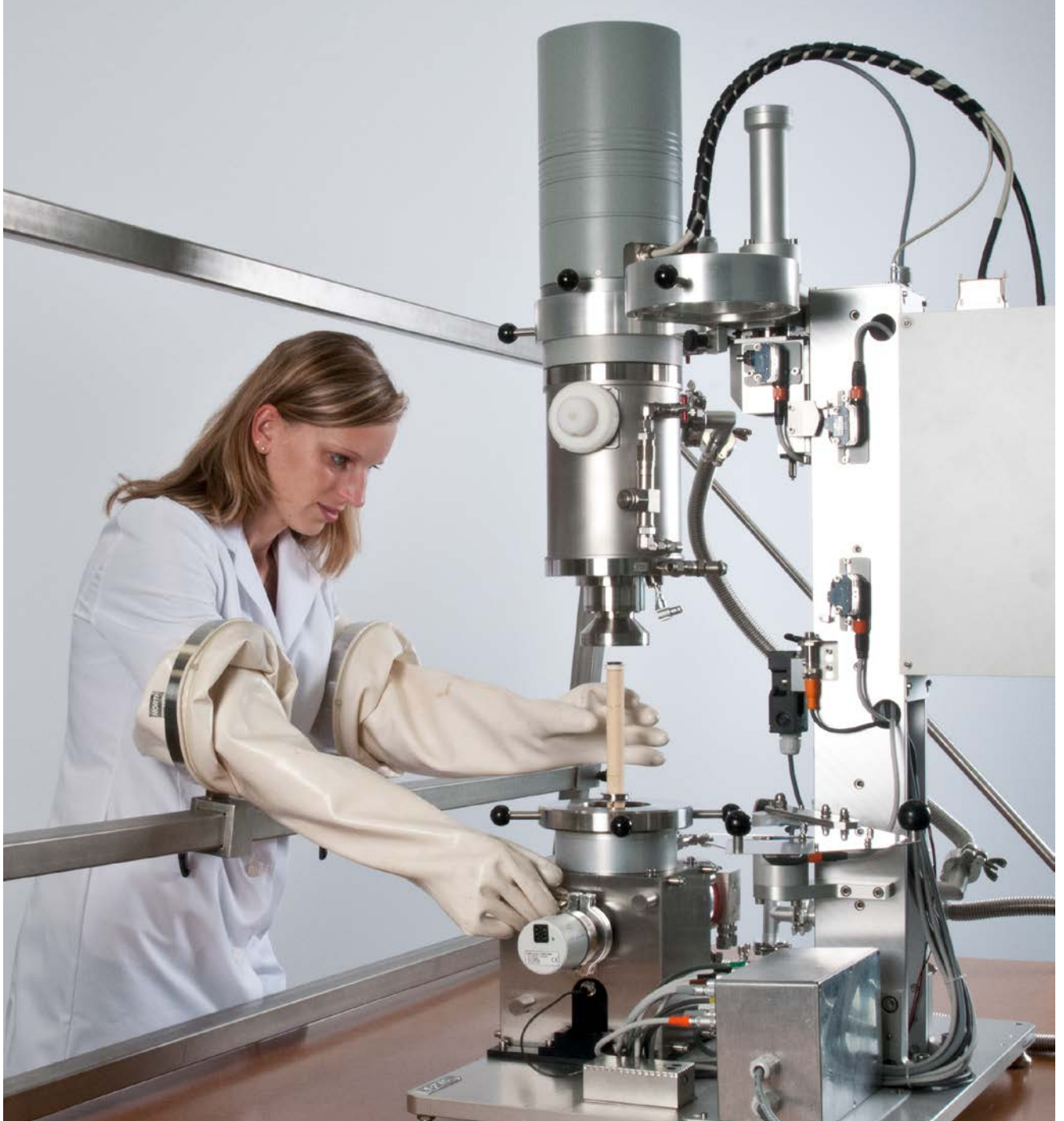
LFA 427 in einer Mockup-Glovebox
