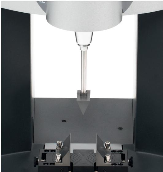
1 Kinexus-Rotationsrheometer mit Texturanalyseeinrichtung zur Charakterisierung spröder Feststoffe (Kekse, Schokolade).
