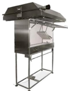
TBB 913 – Brandprüfeinrichtung für Bodenbeläge
