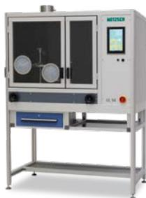
UL 94 – Brandprüfeinrichtung für elektro-technische Produkte
