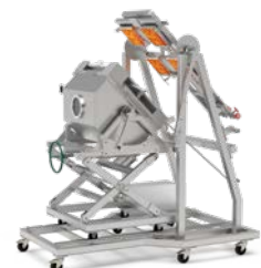
TDP T4 – Dachprüfstand
