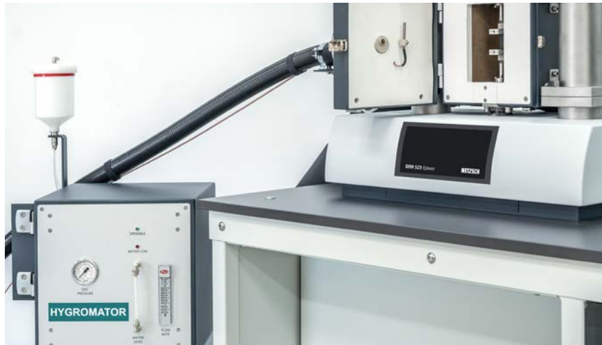
Feuchtegenerator, angeschlossen an den Standardofen
