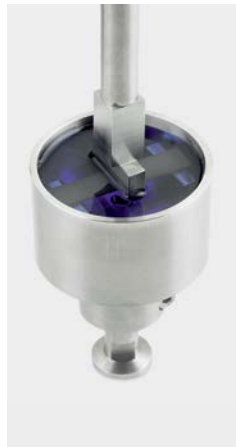
3-Punkt-Biegung mit Immersionsbad
