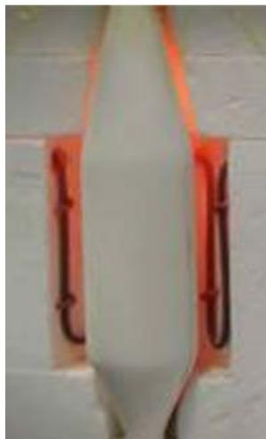
**1** Faserkeramischer Ofeneinsatz (Einsatztemperatur: max. 1300 °C)
