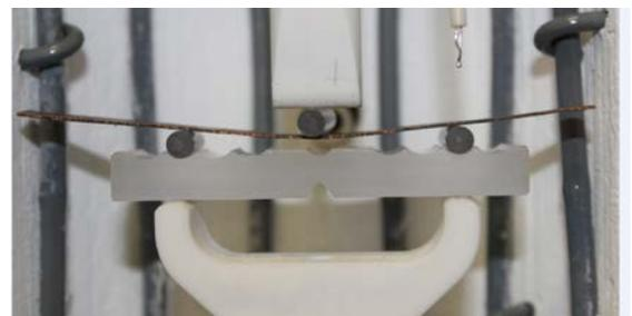
**3** Rollenbiegelager mit zusätzlichem kardanischem Biegestempel
