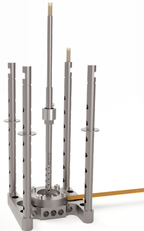
Probenhalter für simultane DMA-DEA
