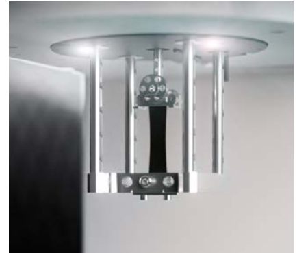
Hängendes Design mit beleuchtetem Probenhalterbereich
