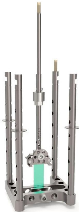
1 Schematische Darstellung einer dünnen rechteckigen Probe, die in den Zugprobenhalter aus Stahl eingesetzt wurde.
