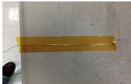
3 Anbringen des Proben-thermoelements
