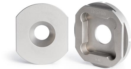
5 Folienprobenhalter für Wärmeleitfähigkeitsmessungen in Dickenrichtung der Dünnschicht
