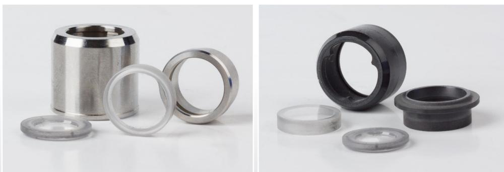
1 Design des neuen Probenhalters für Metallschmelzen; Edelstahl- (Bestell-Nr. LFA46700B96-040-00) und SiC-Version (LFA46700B96-041-00)
