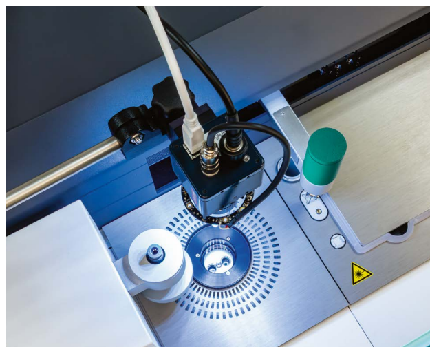
1 DSC-Zelle der DSC 300 Caliris ® mit Kameraoption
