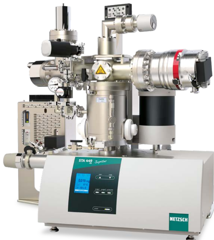
STA 449 F3 Jupiter ® mit MS- SKIMMER -System und einem zweiten Ofen
