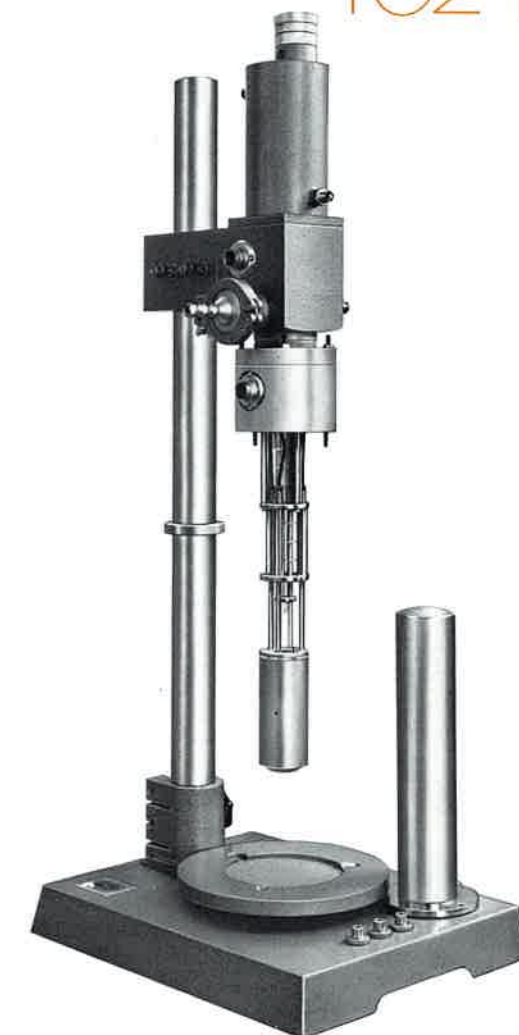
Tieftemperatur-Meßteil 402 T mit bifilarem Widerstandsdrahtofen und Quarzglasprobenhalterung
