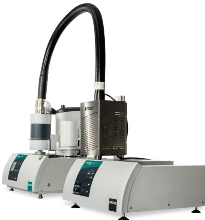
Abb. 3. NETZSCH STA 449 *F3 Jupiter*®, gekoppelt an ein Massenspektrometer QMS 403 *Aëolos*® *Quadro*
